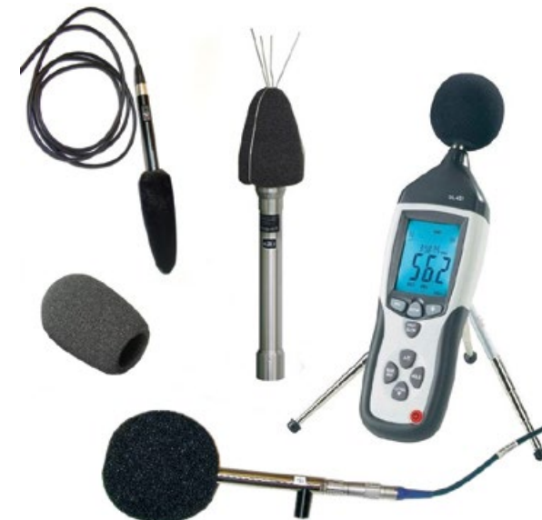
Abb. 2/10 Windschutz an Mikrofonen
