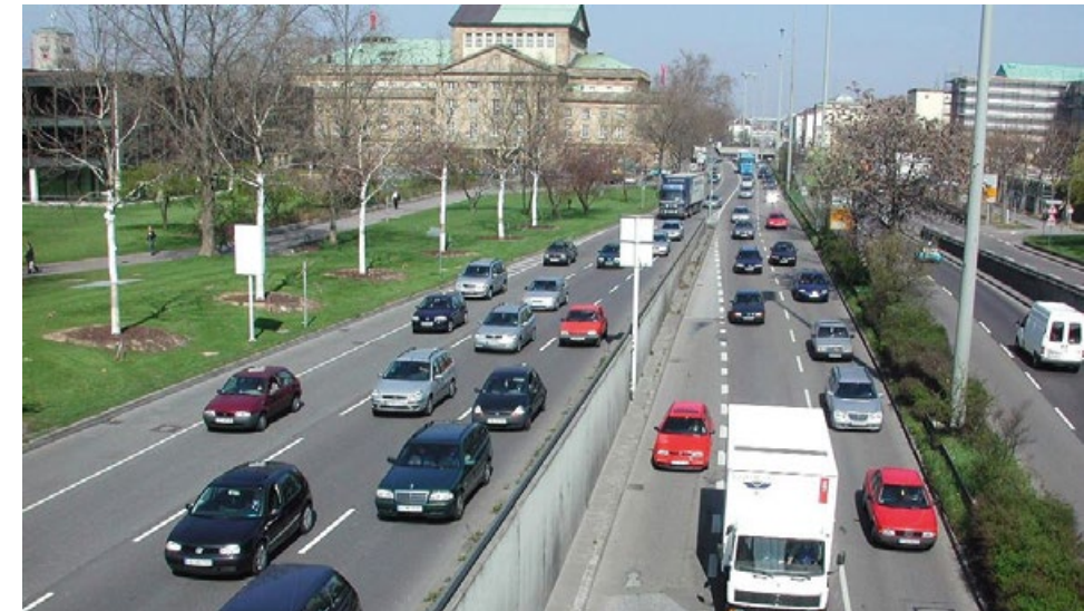
Abb. 2/8 Beispiel einer Linienschallquelle
